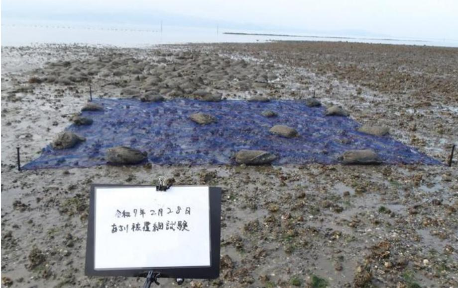
↑：令和 7 年 2 月 28 日に瑞穂の伊福地区で過去に造成された覆砂漁場に設置した被せ網
